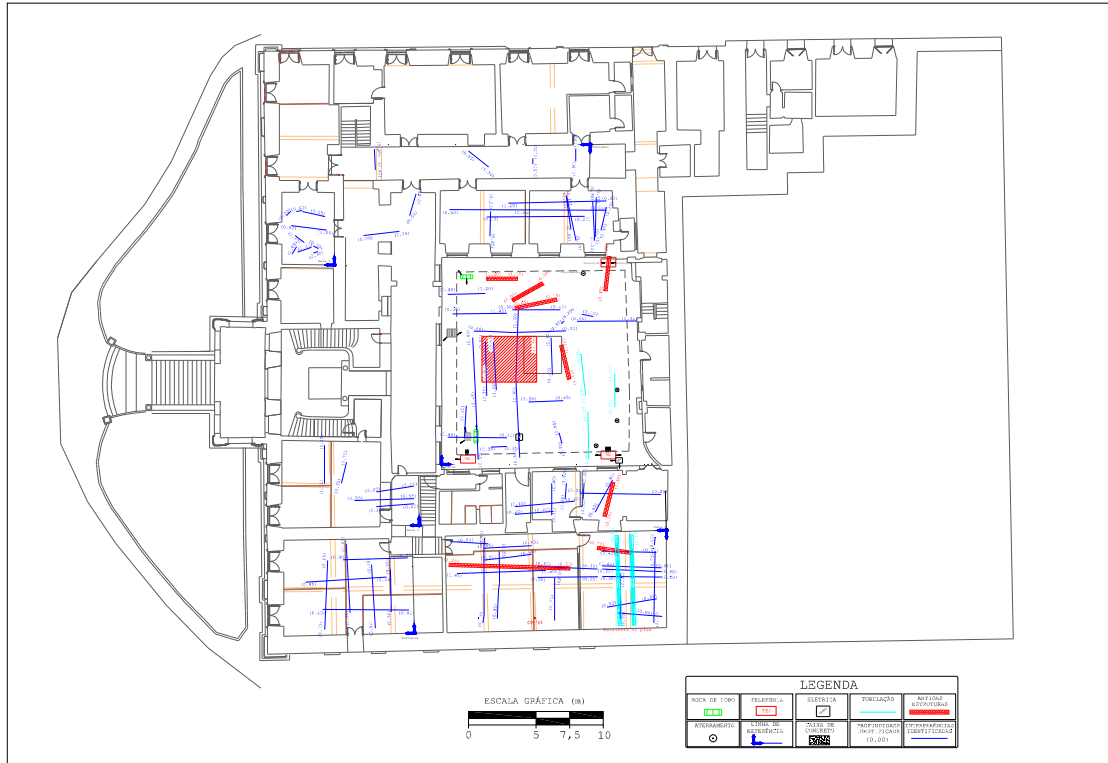
Figura 07 – Linhas de aquisição com o GPR no pavimento térreo.
