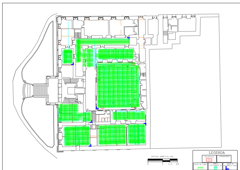
Figura 05 – Linhas de aquisição com o GPR no pavimento térreo.
