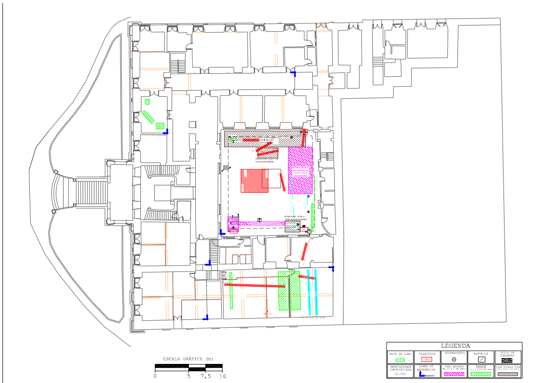
Figura 08 – Linhas de aquisição com o GPR no pavimento térreo.
